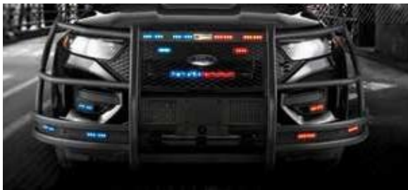
(2) altavoces ES100 montados detrás de la barra central del paragolpes DFC en Ford Police Interceptor Utility
